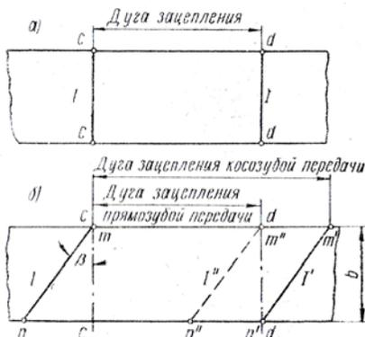
Рис. 4.43. Развертки начальных цилиндров прямозубого (а) и косозубого (б) колес
