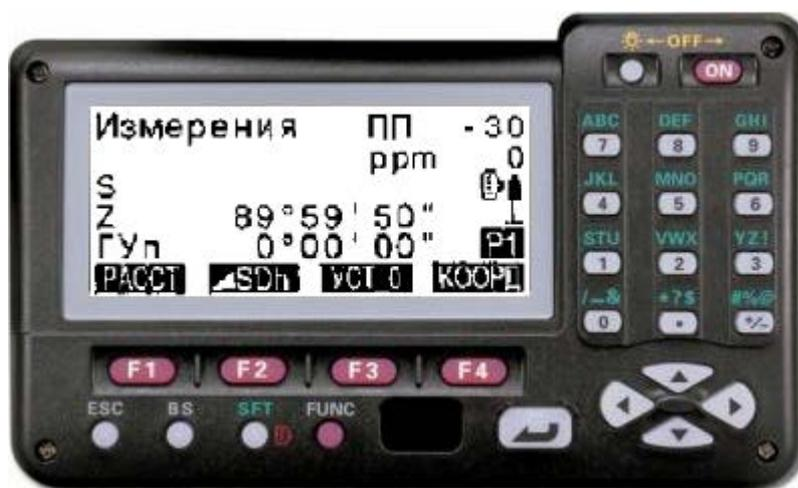
Рис. 7. Дисплей электронного тахеометра Sokkia
