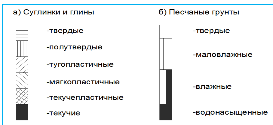
Рис. 6.7 – Условные обозначения консистенции грунтов на геологическом разрезе продольного профиля.
