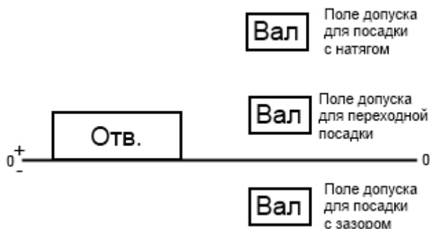
Рисунок 1 – Посадки в системе отверстия
