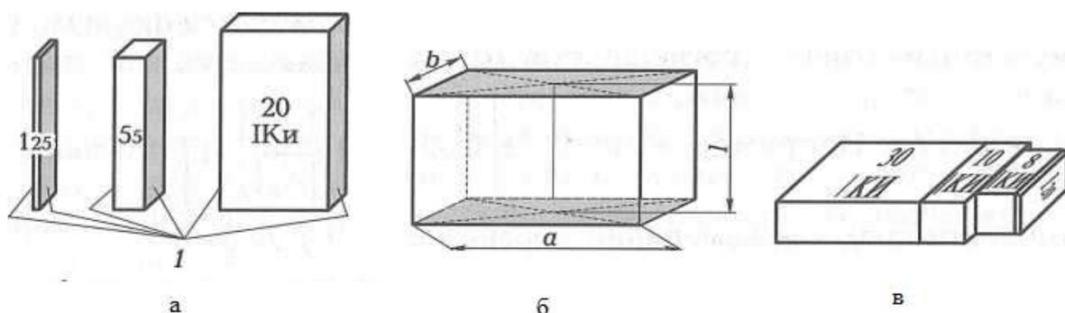
Рисунок 1 - Плоскопараллельные концевые меры длины:
