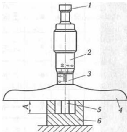
1 – рукоятка трещотки предельного механизма; 2- барабан; 3 – стембель ; 4 – опорная пластина; 5 – микрометрический винт; 6- измеряемая деталь; А - измеряемый параметр
