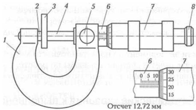
Рисунок 5 – Схема измерения гладким микрометром:
