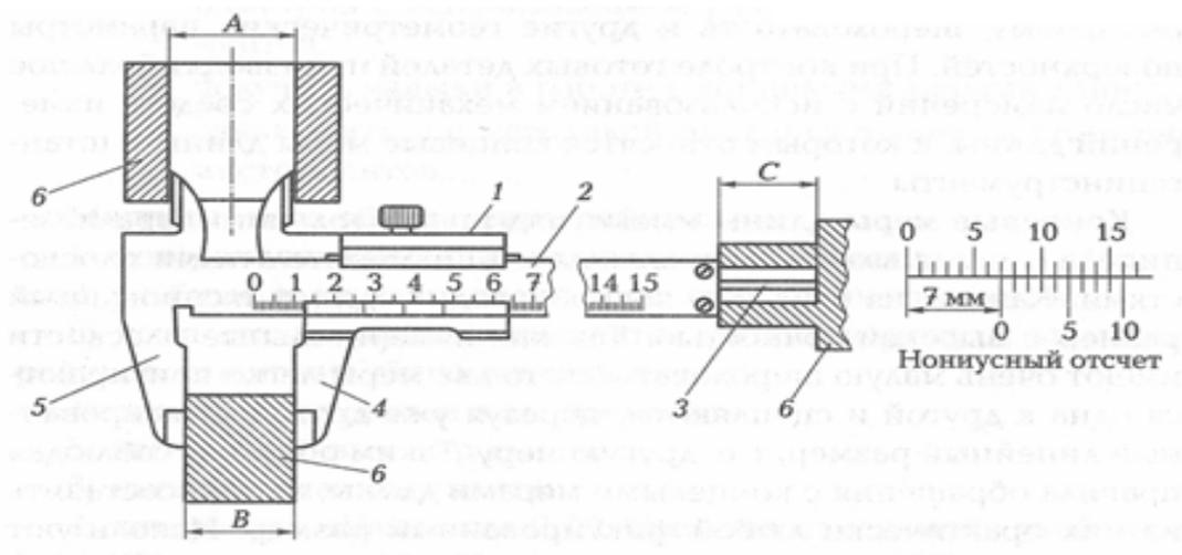
Рисунок 2- Схема измерения штангенциркулем:
