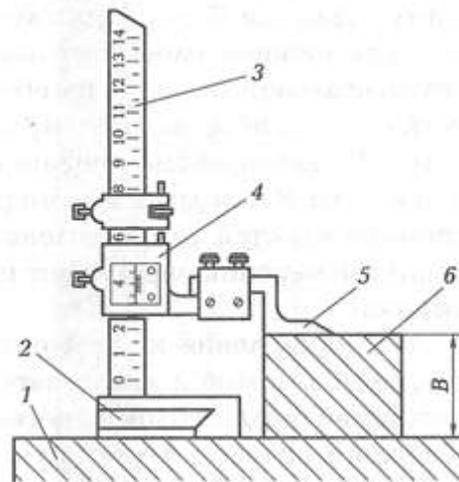
Рисунок 4 – Схема измерения штангенрейсмасом: 1 – инструментальная плита; 2 – основание; 3 – штанга с основной шкалой; 4 – подвижная рамка с нониусной шкалой; 5 – наконечник или измерительная головка; 6 – измеряемая деталь; В – измеряемый параметр
