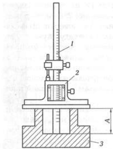
Рисунок 3 – Схема измерения штангенглубиномером:
