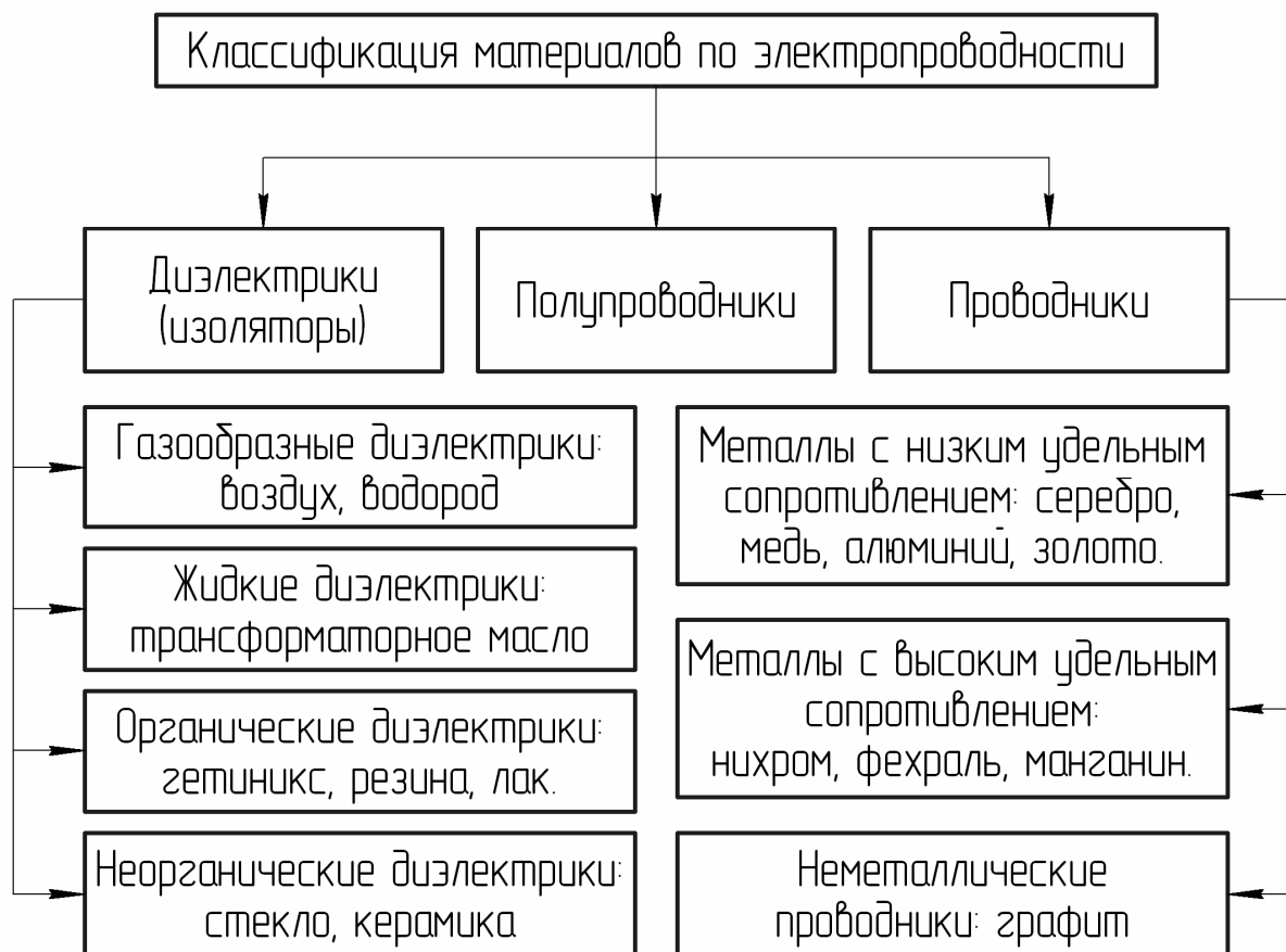
Рисунок 1.9 – Классификация материалов по электропроводности
