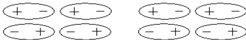
Рис. 3. Схема механизма дисперсионного взаимодействия
