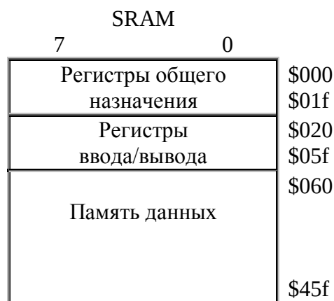
Рисунок 3.3 - Статическая память данных микроконтроллера ATmega 16
