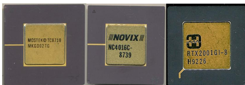
Знаменитые Forth-машины. Слева направо Novix Mostek MKGD02TG, Novix NC4016C (оба 1987 г.), Harris RTX2001G1-8 (1992 г.)
