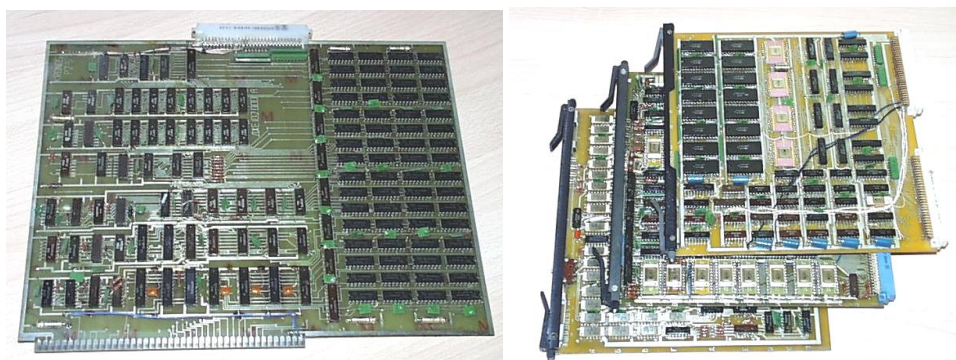
Процессор «Кронос-2.5» и «Кронос-2.6» – АЛУ, ОЗУ и БМУ
