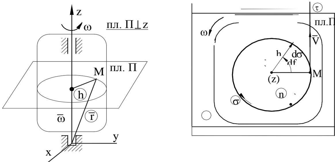
При выводе формулы скорости выбирается произвольная точка тела (т. М). Она движется по окружности радиуса  $h$ . Вводятся криволинейная координатная ось  $\sigma$  и касательная ось  $\tau$ . Тогда можно записать
