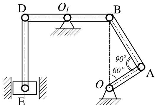
**16.18** Определить скорость поршня  $E$  приводного механизма насоса в положении, указанном на рисунке, если  $OA = 20$  см,  $O_1B = O_1D$ . Кривошип  $OA$  вращается равномерно с угловой скоростью 2 рад/с.
