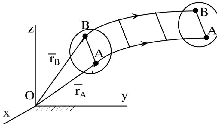
Из определения следует, что при поступательном движении все точки твердого тела движутся по одинаковым траекториям, сдвинутым относительно друг друга. Следовательно, для задания поступательного движения тела достаточно задать движение одной его точки, например, точки A:
