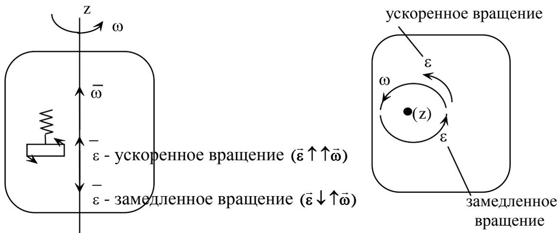
Чтобы в определении угловой скорости учесть и направление вращения тела вводится понятие **вектора угловой скорости**. Он обозначается  $\vec{\omega}$ , расположен на оси вращения и направлен по правилу буравчика. Его величина и проекция на ось z определяются так
