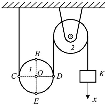
**16.33** Подвижный блок *I* и неподвижный блок *2* соединены нерастяжимой нитью. Груз *K*, прикреплённый к концу этой нити, опускается по вертикали вниз по закону  $x = 2t^2$  м. Определить скорости точек *C*, *D*, *B* и *E*, лежащих на ободе подвижного блока, в момент  $t = 1$  с в положении, указанном на рисунке, если радиус подвижного блока *I* равен 0,2 м, а  $CD \perp BE$ . Найти также угловую скорость блока *I*.
