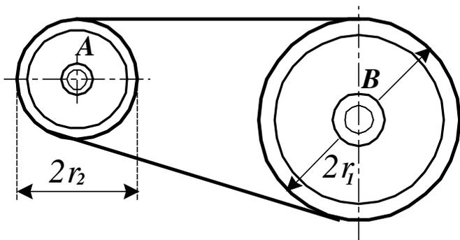
**14.3** Станок со шкивом  $A$  приводится в движение из состояния покоя бесконечным ремнём от шкива  $B$  электромотора; радиусы шкивов:  $r_1 = 75$  см,  $r_2 = 30$  см; после пуска в ход электромотора его угловое ускорение равно  $0,4\pi$  рад/с<sup>2</sup>. Пренебрегая скольжением ремня по шкивам, определить через сколько
