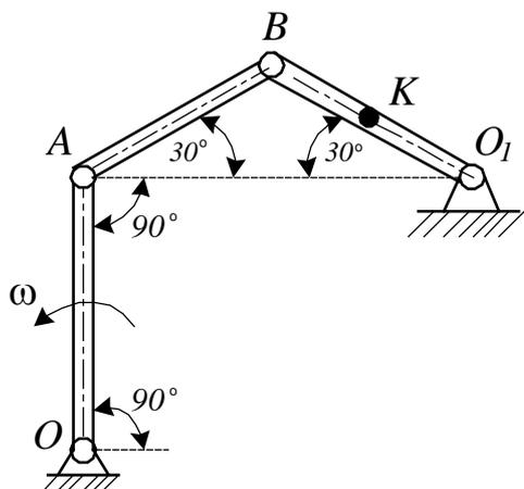
**16.17** Определить скорость точки  $K$  четырёхзвенного механизма  $OABO_1$  в положении, указанном на рисунке, если звено  $OA$  длины 20 см имеет в данный момент угловую скорость 2 рад/с. Точка  $K$  расположена в середине стержня  $BO_1$ .
