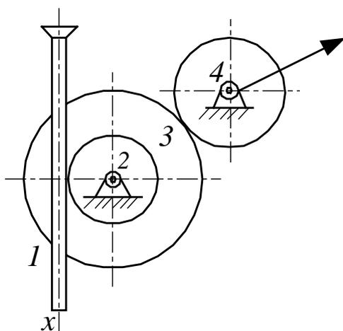
**14.4** В механизме стрелочного индикатора движение от рейки мерительного штифта  $I$  передаётся шестерне  $2$ , на оси которой укреплено зубчатое колесо  $3$ , сцепляющееся с шестерней  $4$ , несущей стрелку. Определить угловую скорость стрелки, если движение штифта задано уравнением  $x = a \sin kt$  и радиусы зубчатых колёс соответственно равны  $r_2, r_3$  и  $r_4$ .
