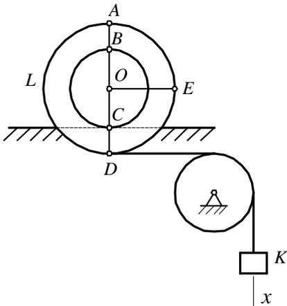
**16.34** Груз *K*, связанный посредством нерастяжимой нити с катушкой *L*, опускается вертикально вниз по закону  $x = t^2$  м. При этом катушка *L* катится без скольжения по неподвижному горизонтальному рельсу. Определить скорости точек *C*, *A*, *B*, *O* и *E* катушки в момент  $t = 1$  с в положении, указанном на рисунке, а также угловую скорость катушки, если  $AD \perp OE$ , а  $OD = 2OC = 0,2$  м.
