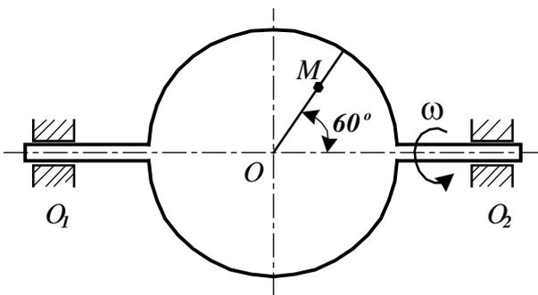
**23.27** По радиусу диска, вращающегося вокруг оси  $O_1O_2$  с угловой скоростью  $\omega = 2t$  рад/с в направлении от центра диска к его ободу движется точка  $M$  по закону  $OM = 4t^2$  см. Радиус  $OM$  составляет с осью  $O_1O_2$  угол  $60^\circ$ . Определить величину абсолютного ускорения точки  $M$  в момент  $t = 1$  с.
