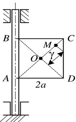
**23.29** Квадрат  $ABCD$  со стороной  $2a$  м вращается вокруг стороны  $AB$  с постоянной угловой скоростью  $\omega = \pi\sqrt{2}$  рад/с. Вдоль диагонали  $AC$  совершает гармоническое колебание точка  $M$  по закону  $\gamma = a \cos(\pi/2) t$  м. Определить величину абсолютного ускорения точки при  $t = 1$  с и  $t = 2$  с.
