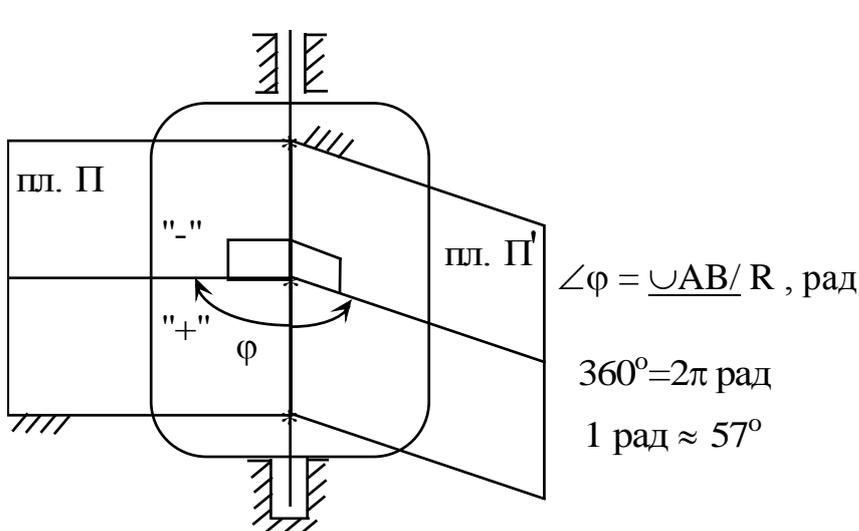
Через неподвижные точки проводится ось - **ось вращения**. Вдоль нее направляется числовая ось, обычно  $z$ . Для задания вращательного движения вводятся две полуплоскости: пл. П - неподвижная; пл. П' - вращается вместе с телом. Угол  $\varphi$  между этими полуплоскостями называется **углом поворота**. Он имеет знак и измеряется в **радианах**:
