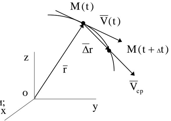
$$\vec{V}(t) = \lim_{\Delta t \rightarrow 0} \frac{\Delta \vec{r}}{\Delta t} = \frac{d\vec{r}}{dt} = \dot{\vec{r}} \text{ - мгновенная скорость}$$
