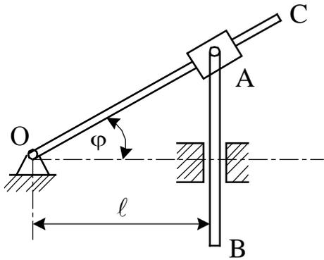
**22.17** В кулисном механизме при качении кривошипа  $OC$  вокруг оси  $O$ , перпендикулярной плоскости рисунка, ползун  $A$ , перемещаясь вдоль кривошипа  $OC$ , приводит в движение стержень  $AB$ , движущийся в вертикальных направляющих  $K$ . Расстояние  $OK = l$ . Определить скорость движения ползуна  $A$  относительно кривошипа  $OC$  в функции от угловой скорости  $\omega$  и угла поворота  $\varphi$  кривошипа.
