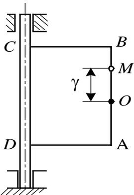
**23.28** Прямоугольник  $ABCD$  вращается вокруг стороны  $CD$  с угловой скоростью  $\omega = \pi/2$  рад/с = const. Вдоль стороны  $AB$  движется точка  $M$  по закону  $\gamma = a \sin(\pi/2) t$  м. Даны размеры:  $DA = CB = a$  м. Определить величину абсолютного ускорения точки в момент времени  $t = 1$  с.
