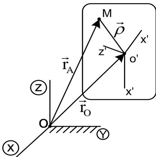
В общем виде эта задача формулируется так. Движение точки М рассматривается в двух системах отсчета: условно неподвижной системе  $(x, y, z)$  и движущейся относительно нее произвольным образом системе  $(x', y', z')$ .
