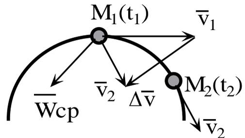
$$\vec{W} = \lim_{\Delta t \rightarrow 0} \frac{\Delta \vec{V}}{\Delta t} = \frac{d\vec{V}}{dt} = \dot{\vec{V}} = \frac{d^2\vec{r}}{dt^2} = \ddot{\vec{r}} \text{ - вектор мгновенного ускорения.}$$
