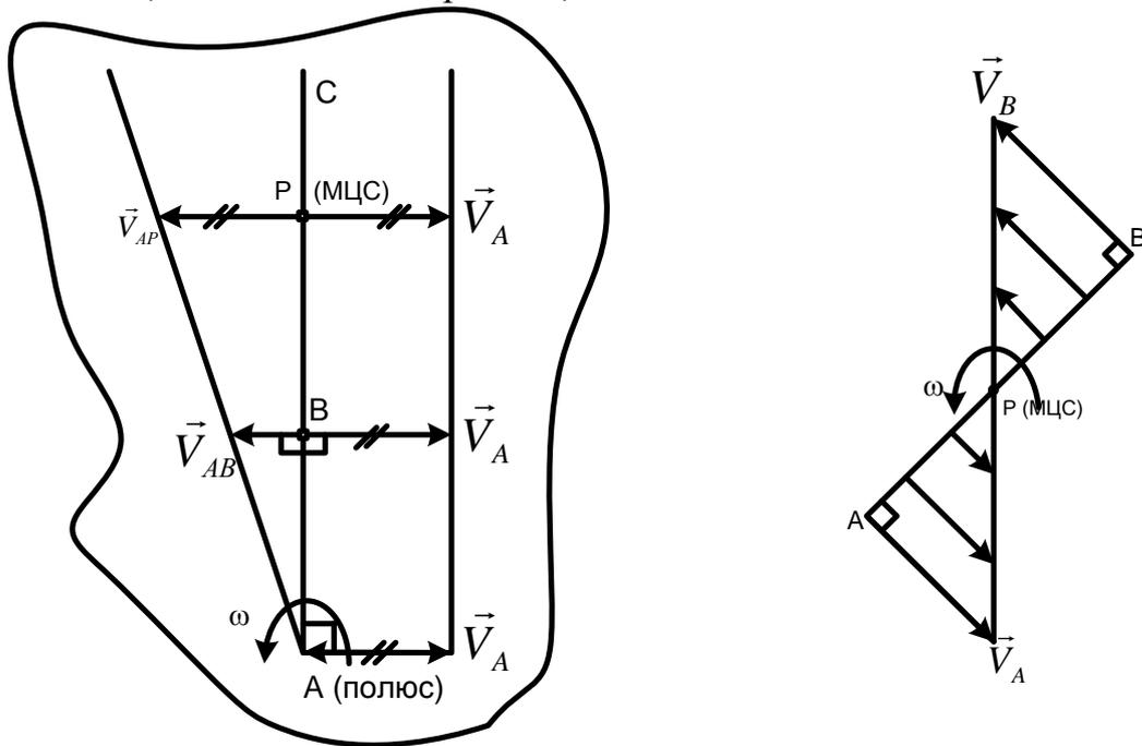
Рассматривается положение фигуры в момент времени  $t$ . К вектору скорости полюса  $\vec{V}_A$  под прямым углом, отсчитываемым в сторону вращения  $\omega$ , строится отрезок  $AC$ . Для произвольной точки этого отрезка можно записать
