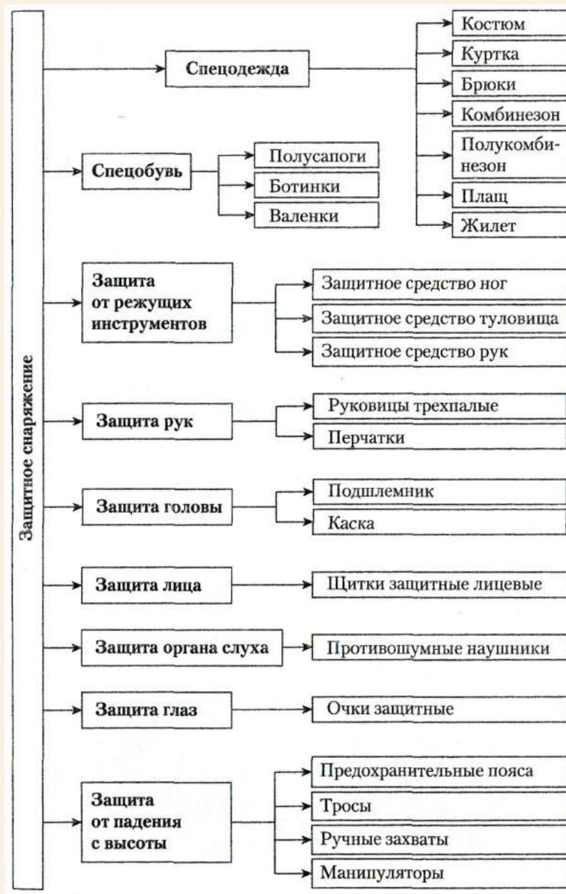
Рис. 7.1. Структурная схема защитного снаряжения
