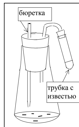
Рис. 5. Установка для титрования раствора щелочи
