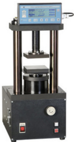
Рис. 20. Измеритель прочности бетона
