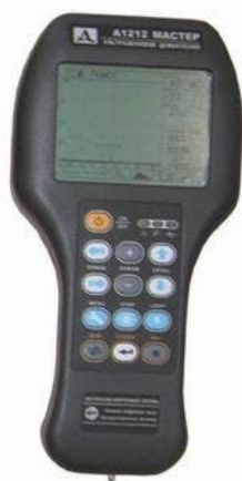
Рис. 26. Ультразвуковой дефектоскоп A1212 МАСТЕР ПРОФИ
