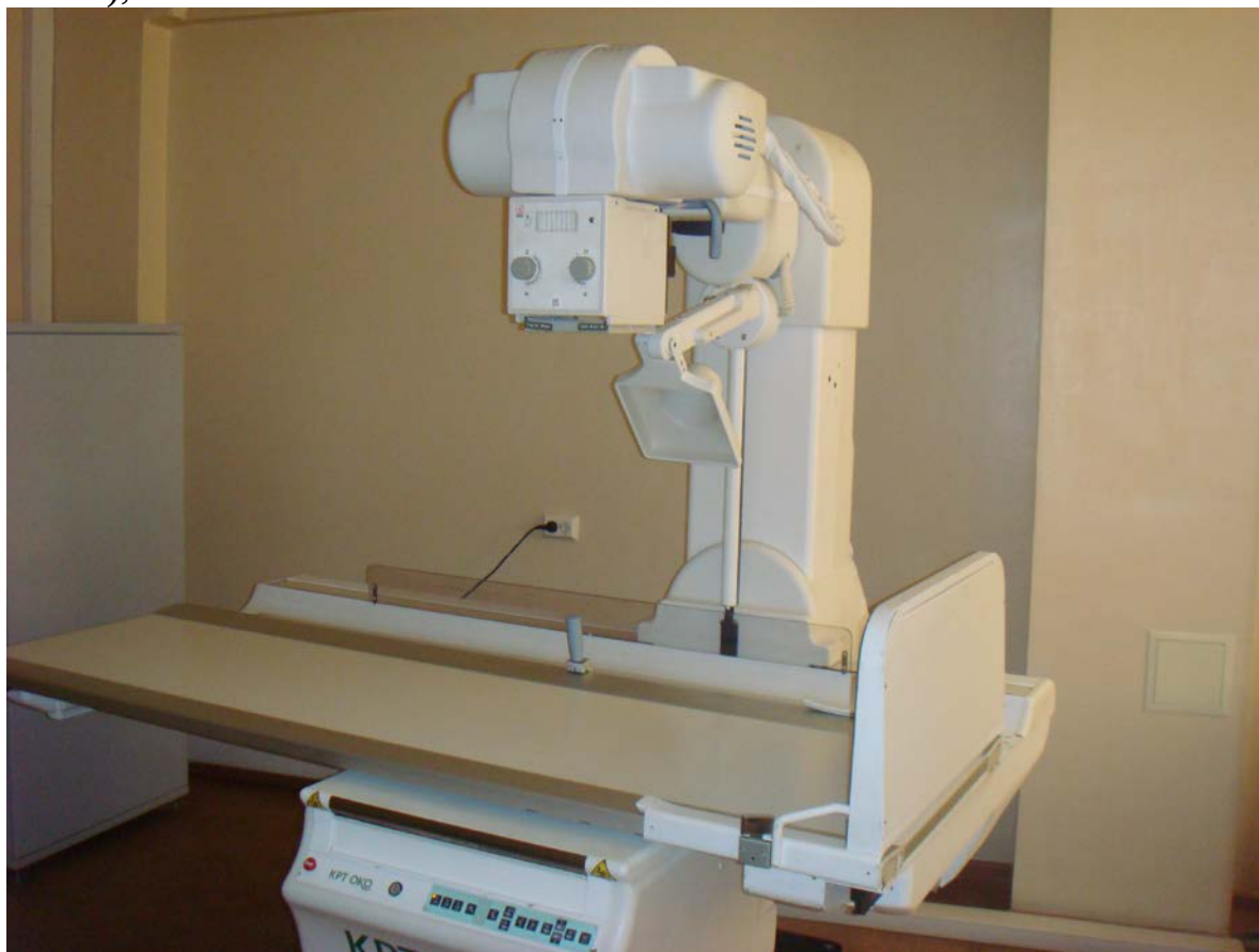
Рис. 1.1. Телеуправляемый стол-штатив OPERA с рентгеновским излучателем, электронно-оптическим преобразователем, ионизационной камерой (экспонометром) и измерительной камерой дозиметра
