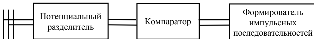
Рис. 3.30. Структурная схема работы БС однофазного мостового выпрямителя
