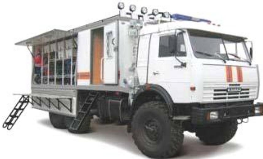
Рисунок 8 – Аварийно-спасательный автомобиль АСА-20 (43114)
