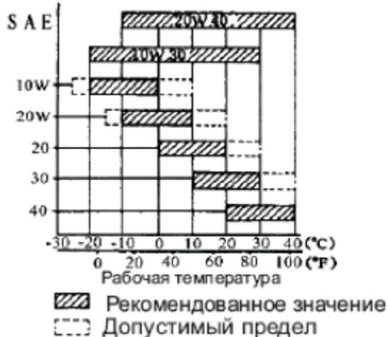
Рисунок 13 – Схема подбора масла по температурному режиму эксплуатации
