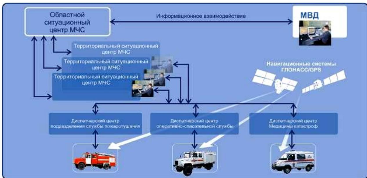
Рисунок 15 – Схема работы навигационной системы ГЛОНАСС/GPS на пожарных и аварийно-спасательных автомобилях в системе МЧС
