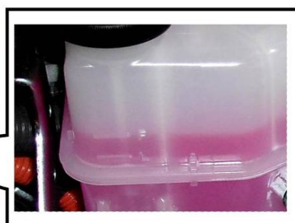
Расширительный бачок гибридной системы
