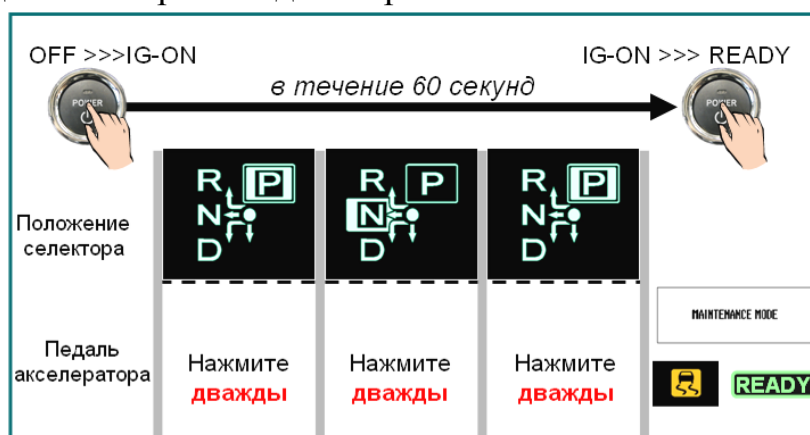
Рис. 106. Тест проверки режима включения двигателя без использования интеллектуального тестера
