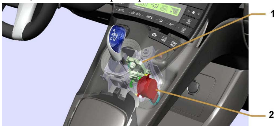
Рис. 79. Датчики положения рычага селектора: 1 - датчик выбора; 2 - датчик переключения
