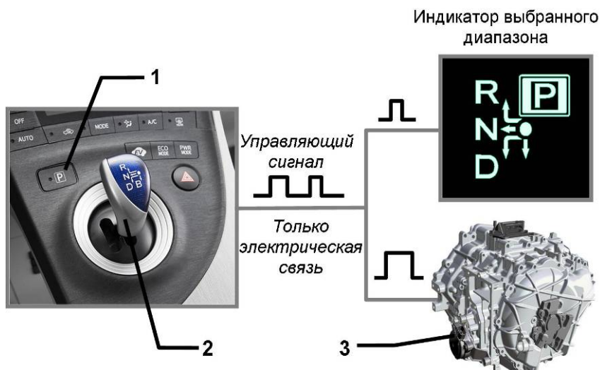
Рис. 75. Электрический селектор диапазонов трансмиссии: 1 - выключатель положения «Р»; 2 - рычаг селектора; 3 - исполнительный механизм блокировки рычага в положении Р
