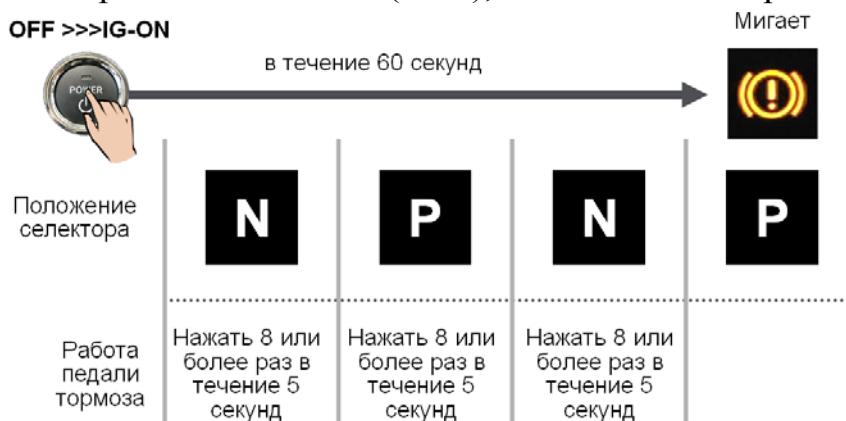
Рис. 104. Последовательность принудительного включения режима отказа электронной тормозной системы (ECB)
