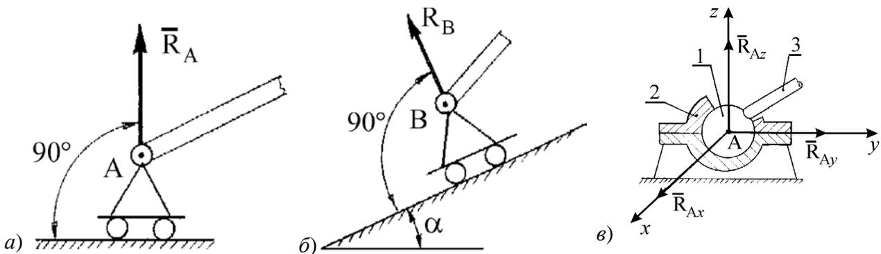
Рис. 1.3. Шарнирно-подвижная опора (а), опора на катках (б), сферический шарнир (в)
