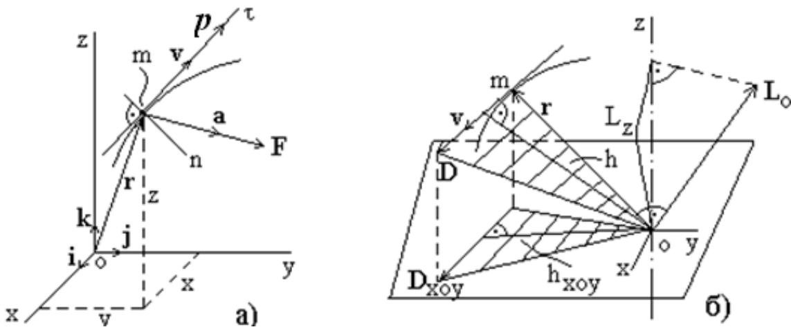
Рис. 3.6. Импульс  $\vec{p}$  (а) и момент импульса  $\vec{L}$  (б) материальной точки
