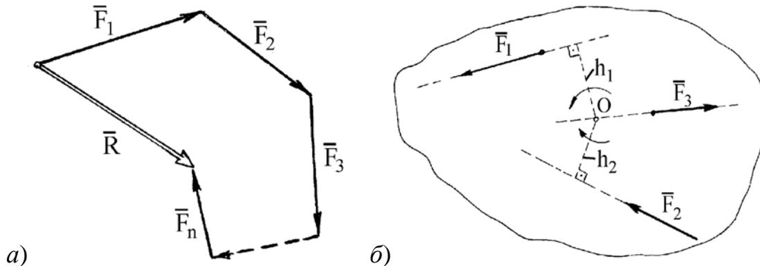
Рис. 1.7. Геометрический метод сложения сил (а). Определение момента силы относительно точки O на плоскости (б)
