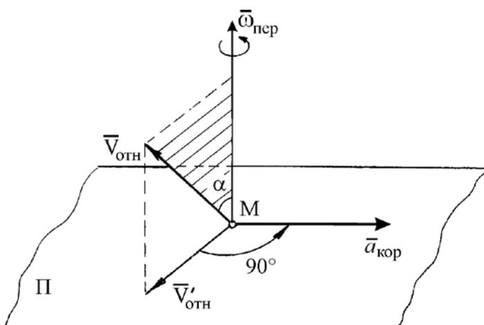
Рис. 2.8. Определение направление вектора кориолисова ускорения  $\bar{a}_{кор}$
