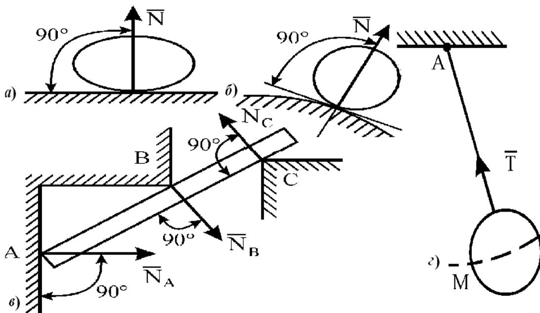
Рис. 1.1. Примеры наиболее часто встречающихся типов связей: в случае гладкой плоскости (а, б), опоры (в), гибкой нерастяжимой нити (г)
