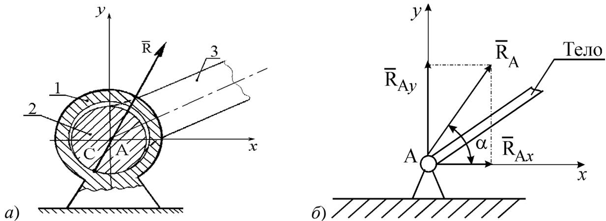
Рис. 1.2. Цилиндрический шарнир/подшипник (шарнирно-неподвижная опора) (а) и ее расчетная схема (б)
