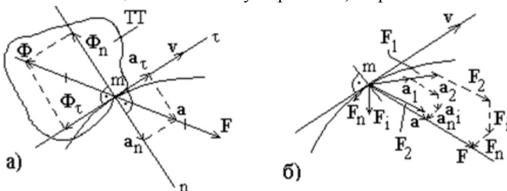
Рис. 3.2. Сила действия и сила инерции (а); сложение ускорений (б)
