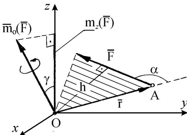
Рис. 1.9. Определение момента силы  $\vec{F}$  относительно центра  $O$
