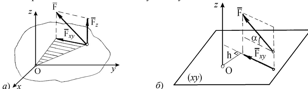
Рис. 1.10. Определение момента силы  $\bar{F}$  относительно оси  $z$ , проходящей через центр  $O$  (а) и схема его расчета (б)
