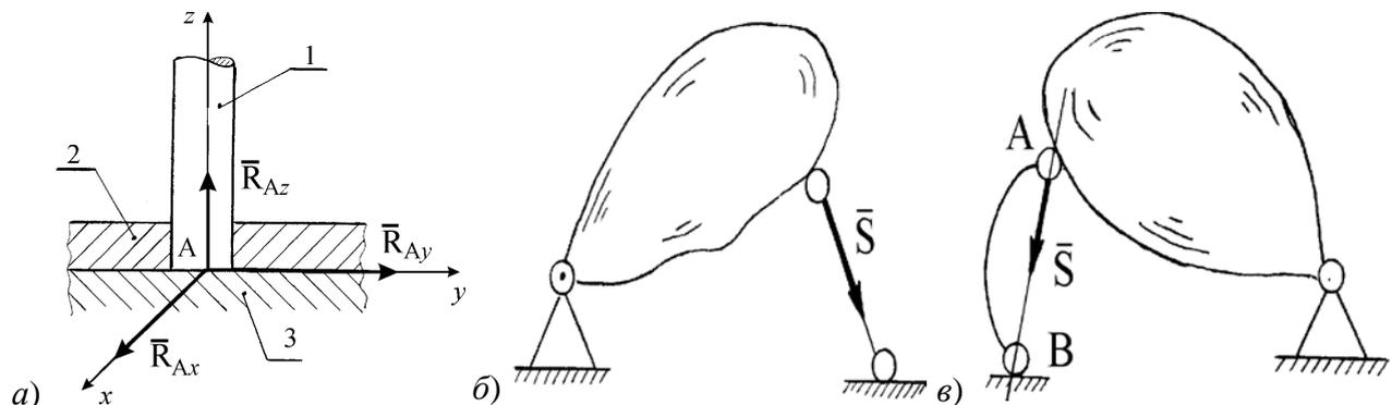
Рис. 1.4. Подпятник (а), невесомые прямолинейный (б) и криволинейный (в) стержни
