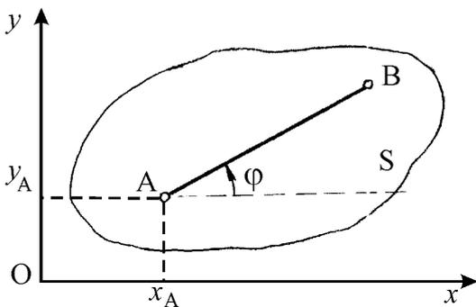
Рис. 2.3. Положение отрезка  $AB$ , с которым неизменно связана фигура  $S$
