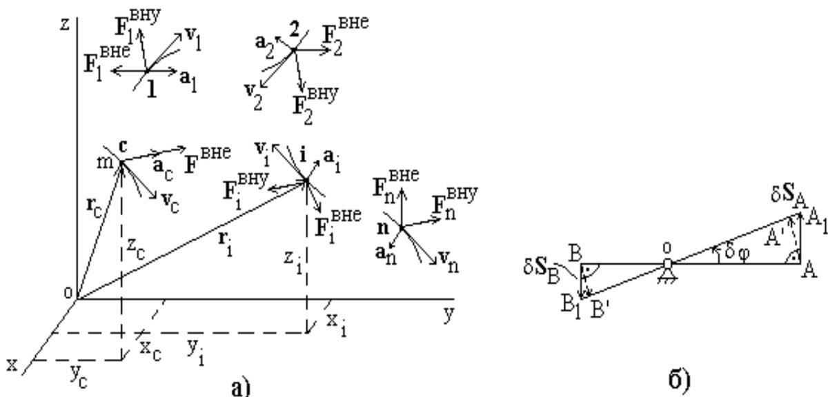
Рис. 3.7. Определение центра масс (а); возможные перемещения рычага (б)
