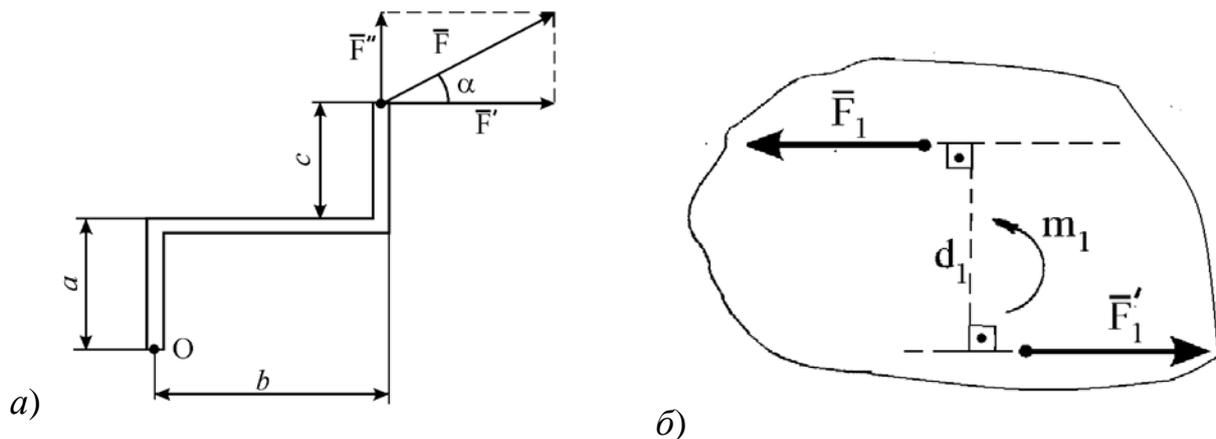
Рис. 1.8. Иллюстрация теоремы Вариньона (а). Пара сил (б)
