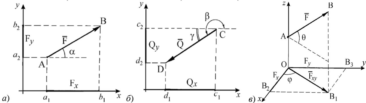
Рис. 1.6. Проекция сил на оси координат (а и б) и плоскость (в)
