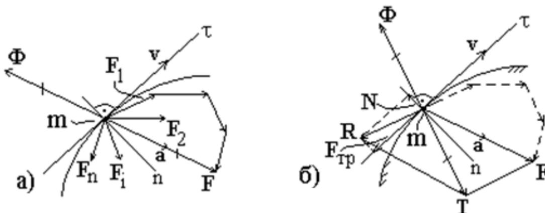
Рис. 3.3. Применение принципа Даламбера для свободной (а) и несвободной (б) точки
