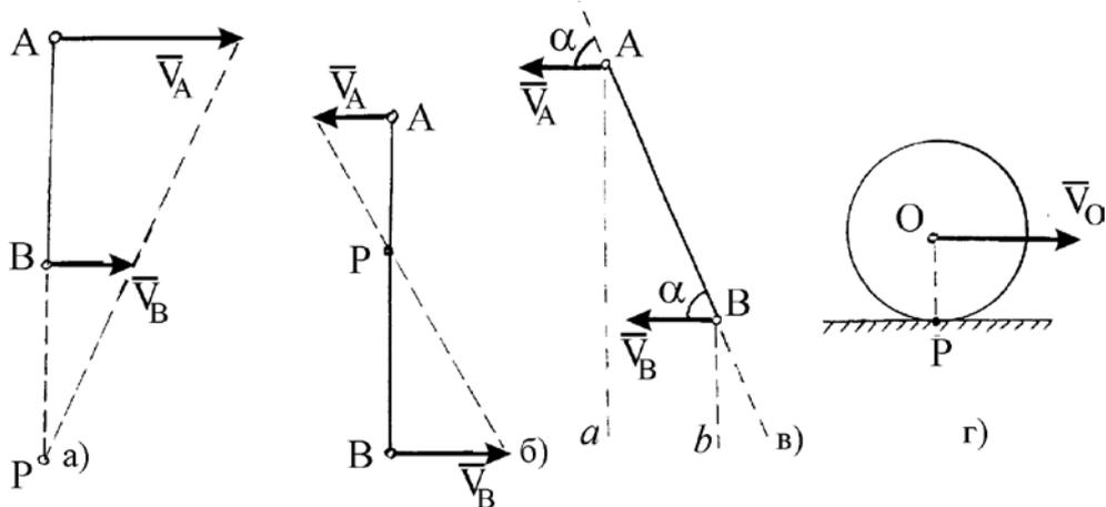
Рис. 2.5. Методы нахождения положения МЦС, применяемые при решении задач
