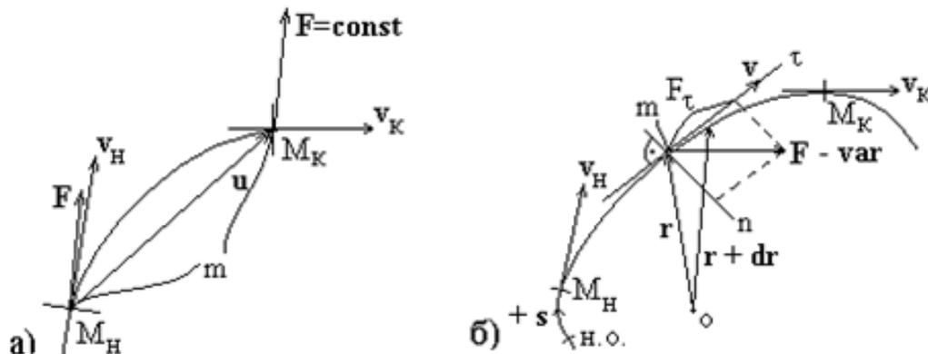
Рис. 3.5. Определение работы для постоянной (а) и переменной (б) силы
