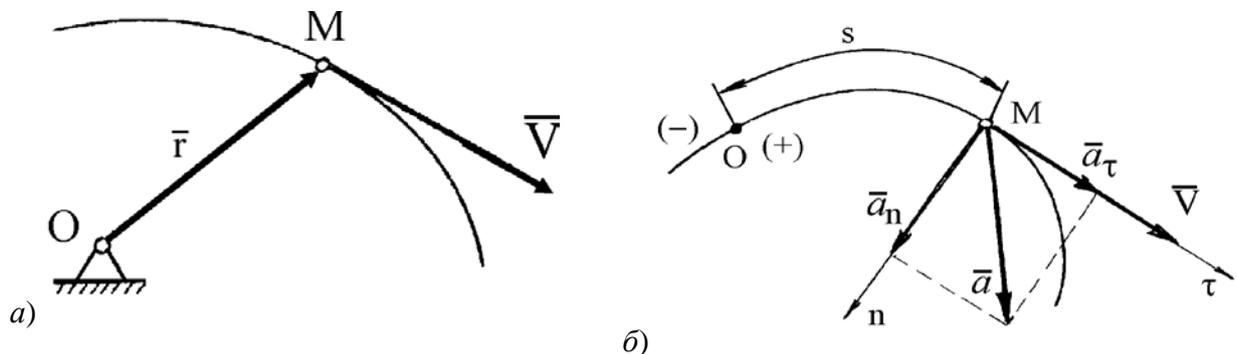
Рис. 2.1. Векторный (а) и естественный (б) способы определения движения точки
