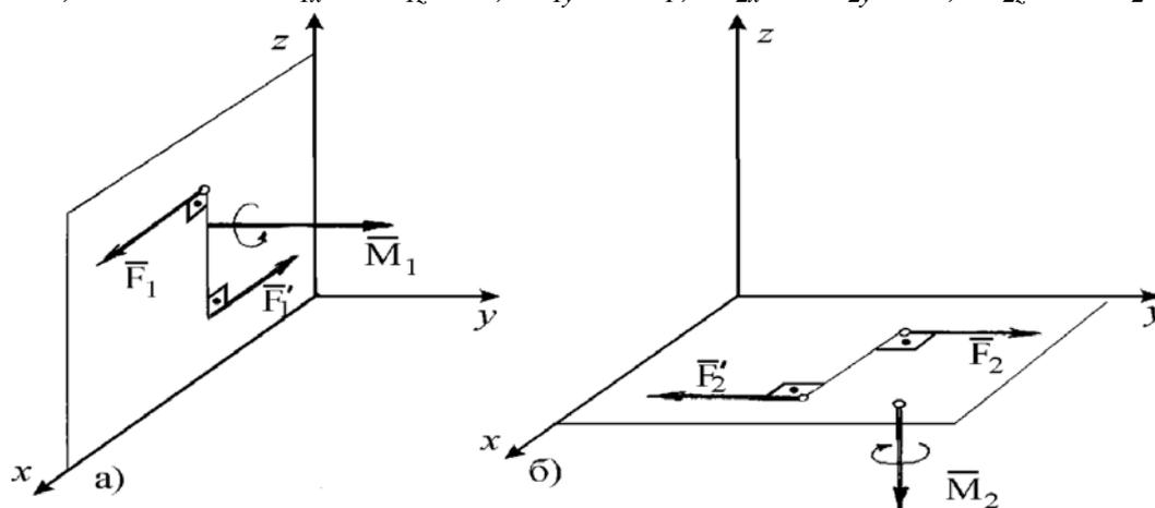
Рис. 1.11. Определение момента пары сил как вектора
