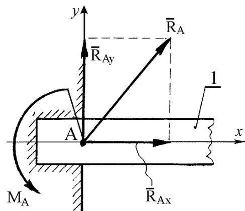
Рис. 1.5. Жесткая заделка (неподвижное защемление)
