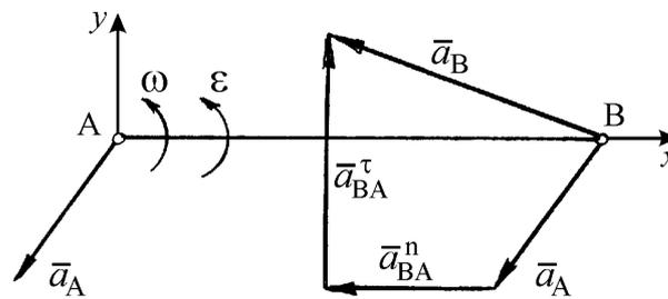
Рис. 2.6. Определение ускорения любой точки  $B$  фигуры ( $\bar{a}_A$  - ускорение полюса  $A$ )
