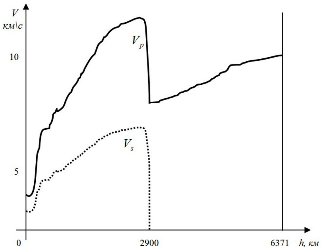
Рис. 1.1. Скорости распространения продольных ( V_p ) и поперечных ( V_s ) сейсмических волн внутри Земли
