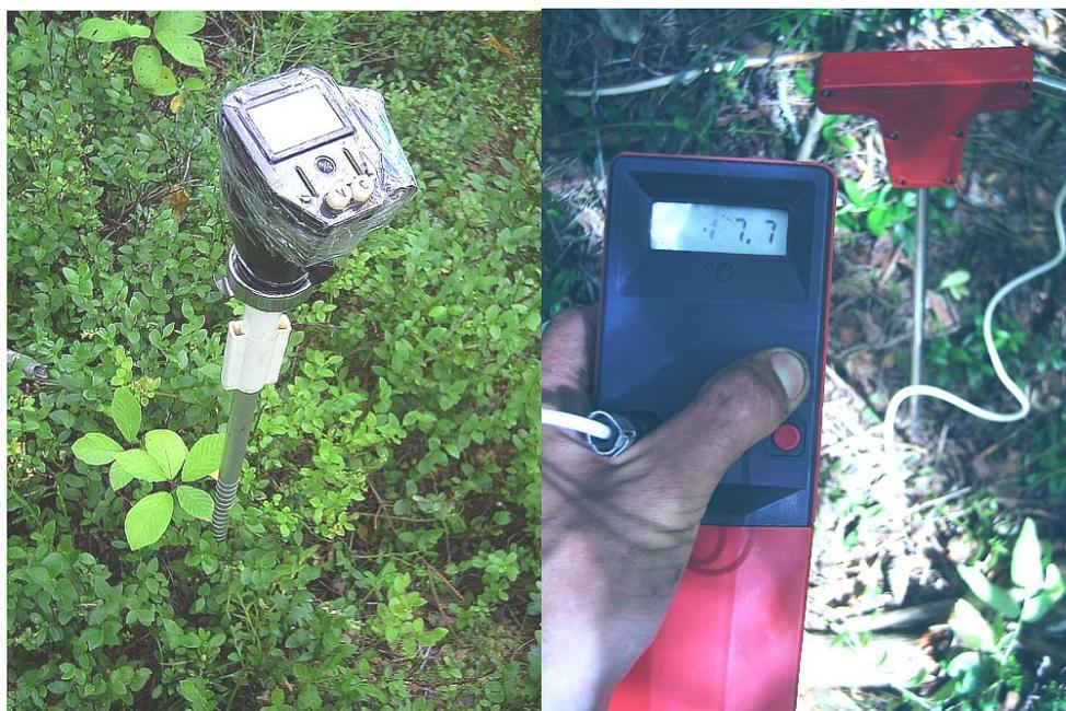
*Рис. 1. Электронные термометры для торфяных почв*
