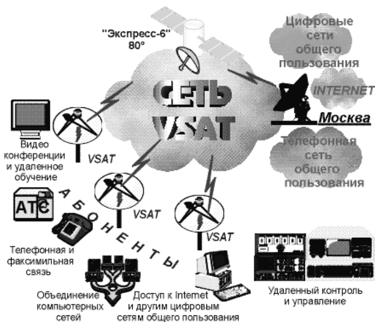
Рис. 24. Структура системы спутниковой связи на примере сети VSAT ГП "Космическая" связь"
