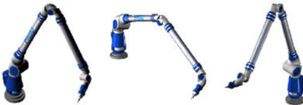
Рис. 2.11. Различные положения откалиброванного щупа КИМ
