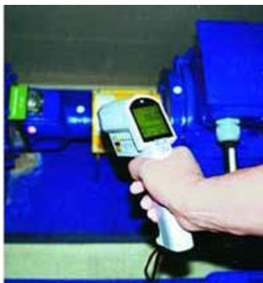
Рис.2.74. Оценка степени износа подшипников до их полного повреждения
