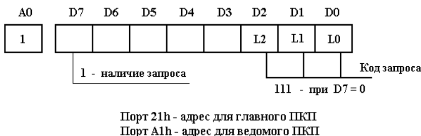
Рис.1.6. Формат регистра состояния контроллера прерываний в режиме опроса
