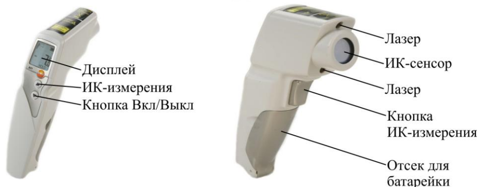
Рисунок 12 - Внешний вид и основные органы управления прибора "термометр инфракрасный Testo 831"
